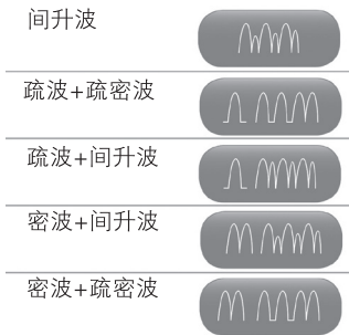
图 2-2 间动电流的脉冲波形示意图
