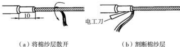
图 1-22 花线绝缘层的剖削
