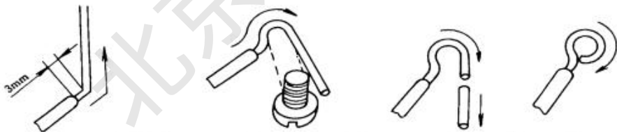
(a) 离绝缘层根部约 3 mm 处向外侧折角 (b) 按略大于螺钉直径弯曲圆弧 (c) 剪去芯线余端 (d) 修正圆圈致圆
