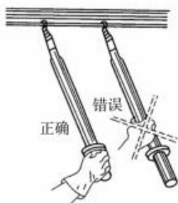
图 1-10 高压验电器的握法
