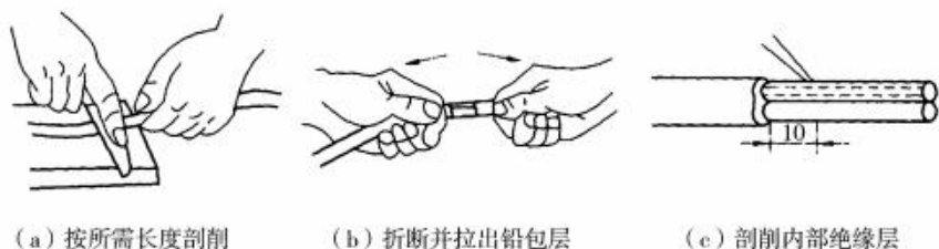
图 1-23 铅包线绝缘层的剖削
