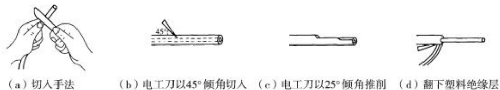
图 1-19 电工刀剖削塑料硬线绝缘层
