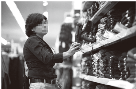
图 1-11 手持终端扫描牛仔裤 RFID 标签
