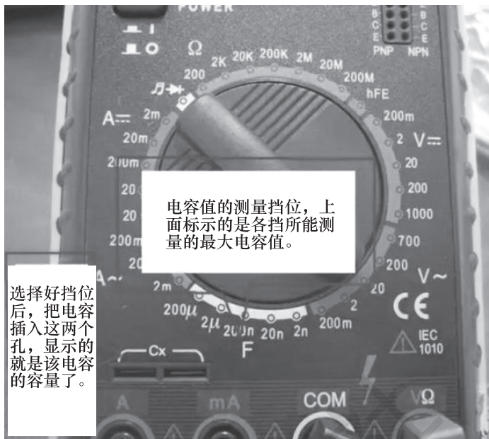
图 2-1-12 应用数字万用表测量电容
