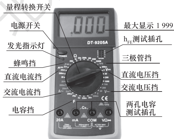
图 2-1-5 DT-9205A 型数字万用表外形图
