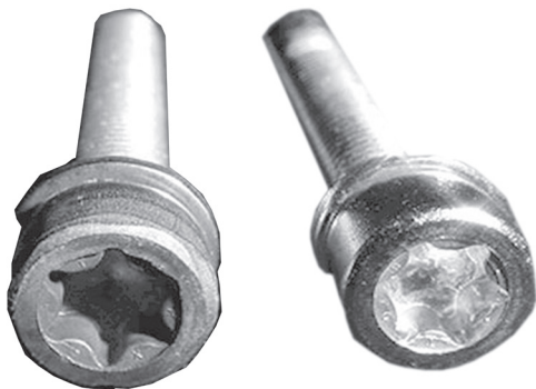
图 1-9 经过 2560 小时盐雾试验后，钝化处理的螺栓（左）和普通电镀螺栓（右）的区别
