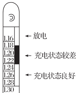
图 2-6 密度计测量方法
