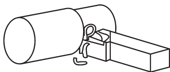
图 1-19 C 形屑折断过程
