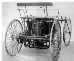
图 1-46 戴姆勒汽车上的钢轮箍制动装置
