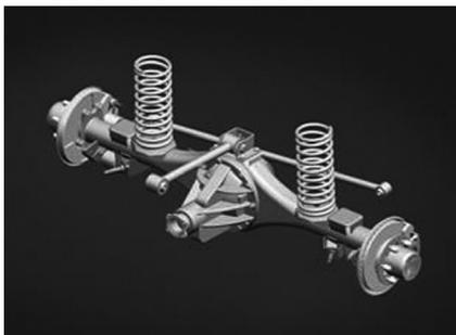
图 1-65 后螺旋弹簧悬架
