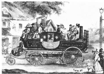
图 1-16 第一辆正式运营的蒸汽公共汽车
