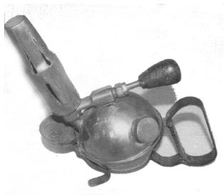
图 1-69 热管式点火装置
