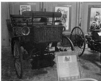
图 1-51 法国的齿轮传动钢轮汽车
