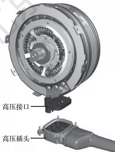
图 2-19 电动机高压接口
