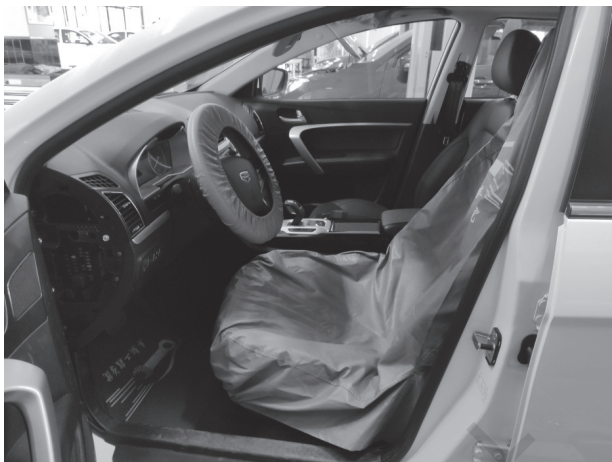
图 2-1-32 安装车内三件套
