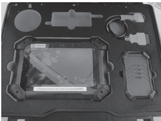
图 2-1-21 吉利 EV300 纯电动汽车配套的诊断仪
