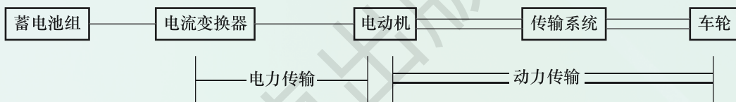
图 2-1-13 单一蓄电池作为动力源的纯电动汽车的电力和动力传输系统
