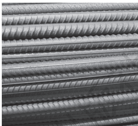
图 2-10 热轧带肋钢筋
