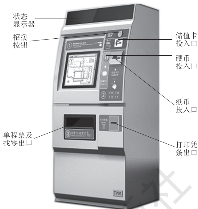
图 2-6 自动售票机外观结构图
