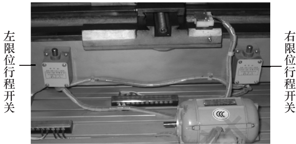
图 1 - 35 设备运动工作台的左、右限位行程开关安装图
