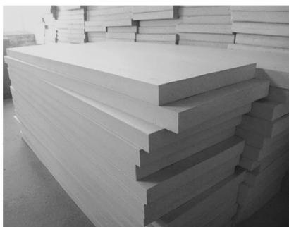
图 1-1-15 硬质聚氨酯泡沫塑料外形结构
