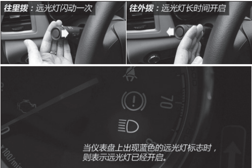
图1-20 前照灯打开方法示意图
