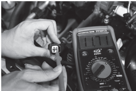
图1-69 检查IG供电电路
