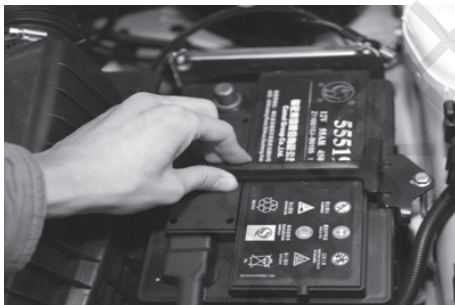
图1-11 检查蓄电池安装情况
