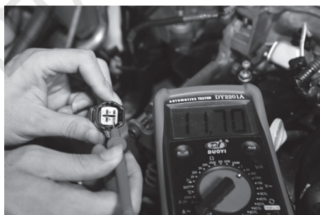
图1-72 端子L与搭铁之间的阻值应为无穷大 图1-73 检查端子S至搭铁电压
