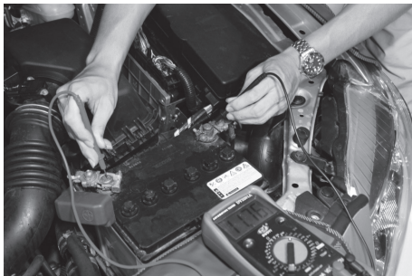
图1-13 检查蓄电池电压
