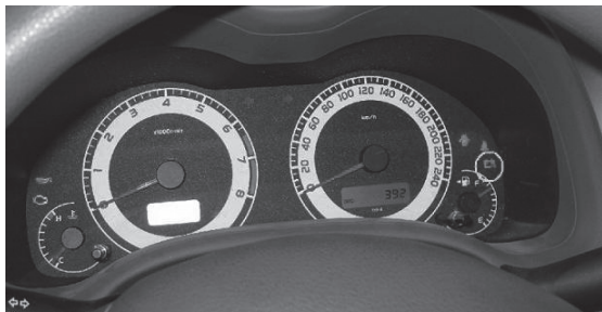
图1-46 充电指示灯检查
