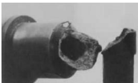
图 2-2-15 脆性断裂失效
