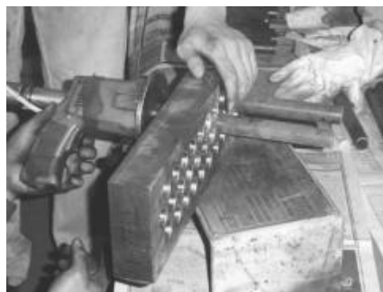
图 2-3-12 换热管与管板的连接
