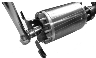
图 1-3-5 用套筒扳手旋下甩油转盘 固定螺母
