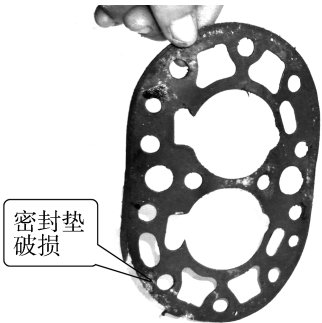
图 1-2-6 需更换的破损的密封垫
