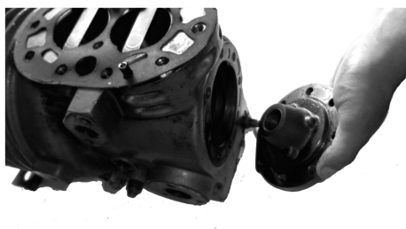
图 1-3-2 拆卸曲轴箱侧盖
