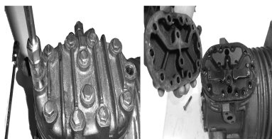
图 1-1-3 拆卸气缸盖和底盖
