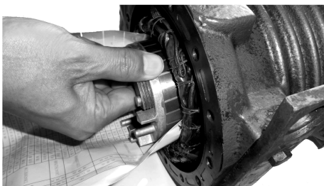
图 1-3-11 安装电动机转子
