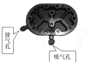
图 1-1-4 吸、排气孔的位置
