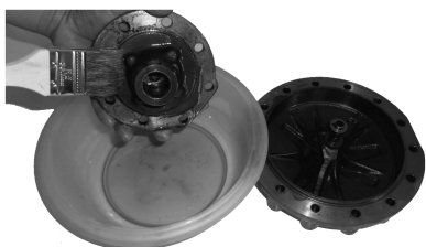
图 1-1-5 气缸盖和底盖等彻底清洗
