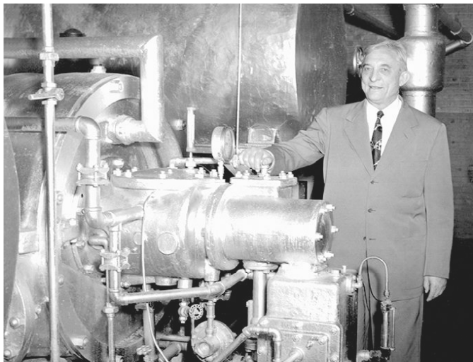
图 1-1-1 开利和他的第一台离心式制冷机
