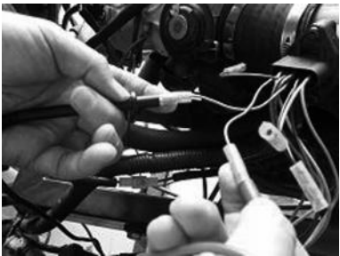
图 1-2-22 测量静态信号电压
