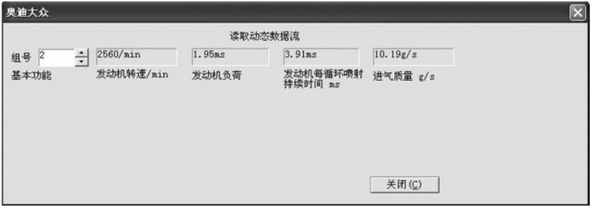
图 1-2-17 发动机转速 2500r/min 时的数据流
