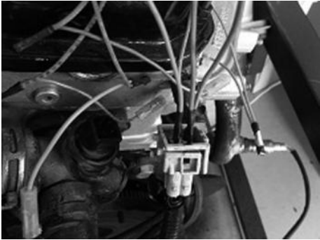
图 1-1-15 冷却液温度传感器单体检测接线
