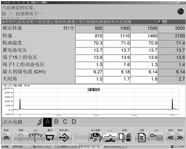
图 1-61 A4 (一缸 4 组转速) 初级点火波形及参数
