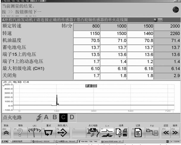
图 1-63 C4 (三缸 4 组转速) 初级点火波形及参数
