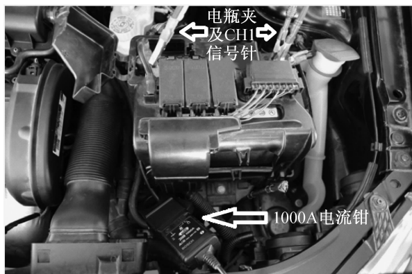
图 1-33 电流钳夹在蓄电池端起动机电缆（POLO 车）
