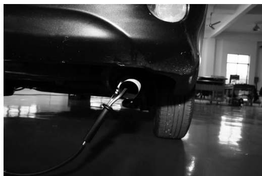
图 1 - 103 尾气传感器插入排气管
