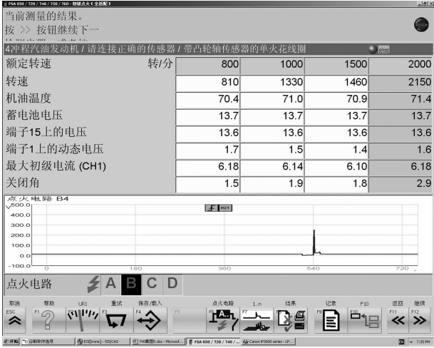
图 1-62 B4 (二缸 4 组转速) 初级点火波形及参数
