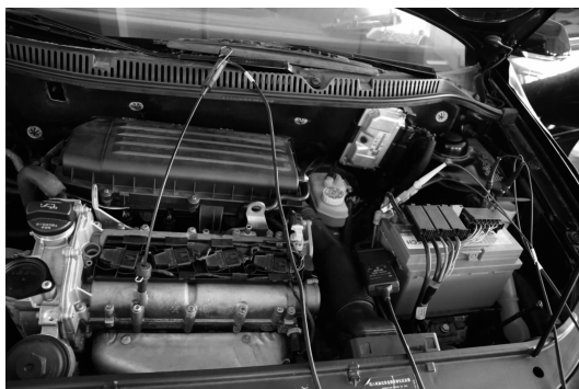
图 1-42 发电机测试连接示意图
