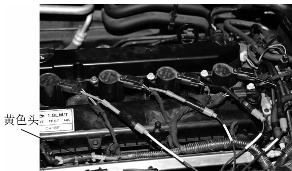
图 1-54 黄色头接电压 15，其他各线接的是各缸 1/-线脚
