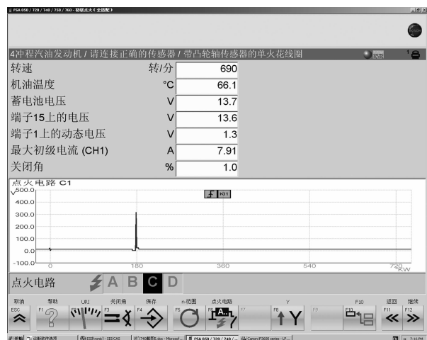
图 1-58 C 端（三缸）点火初级波形
