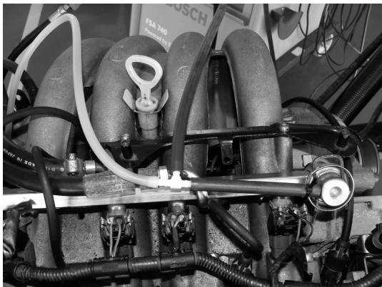
图 1-80 T 形管接入进气支管
