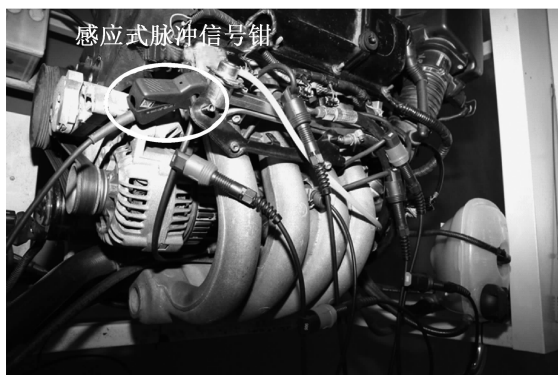
图 1-69 发动机台架的连接图
