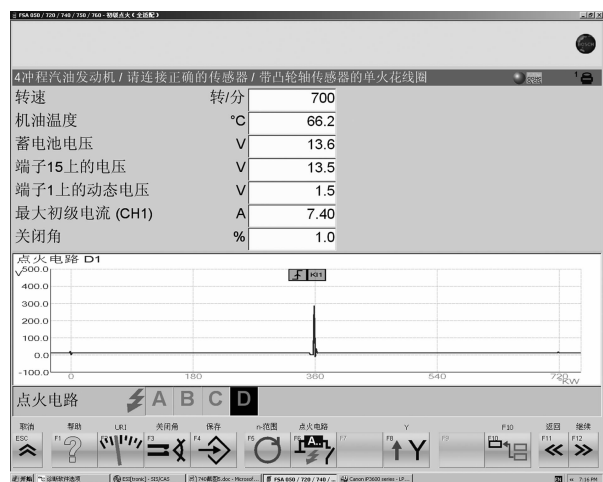
图 1-59 D 端（四缸）点火初级波形
