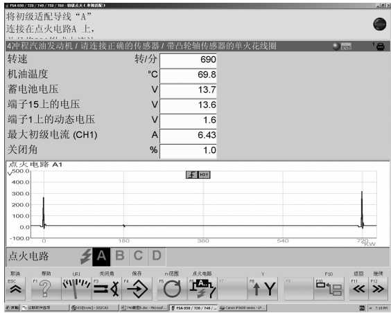
图 1-67 单独适配时 A 端（一缸）波形
