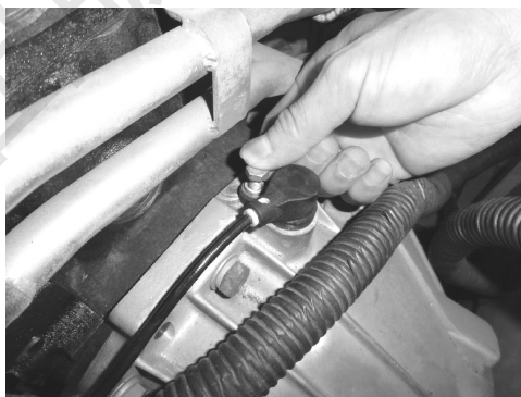
图 1-8 拆卸曲轴位置传感器的固定螺栓 2
