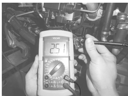
图 1-18 起动机带动曲轴转动 时 ECU 输出的电压值
