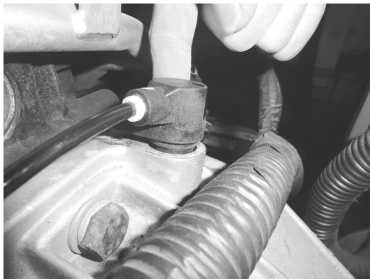
图 1-10 安装新的曲轴位置传感器
