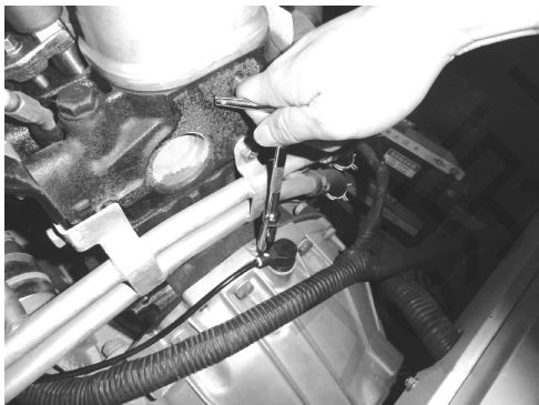
图 1-7 拆卸曲轴位置传感器的固定螺栓 1
