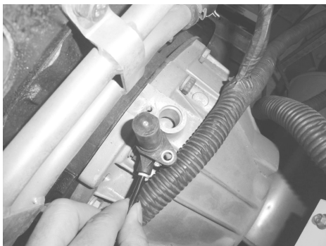
图 1-9 拆下曲轴位置传感器
