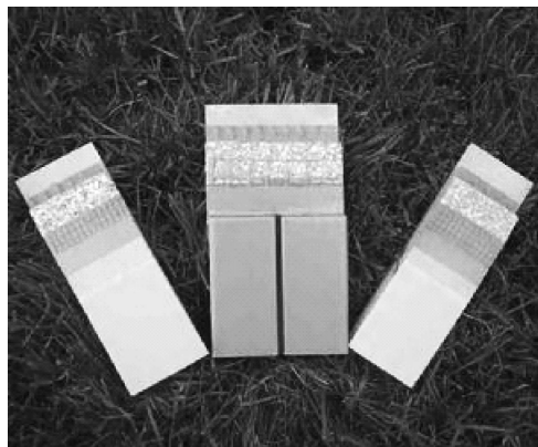
图 2-3 胶粉 EPS 颗粒浆料外保温系统
