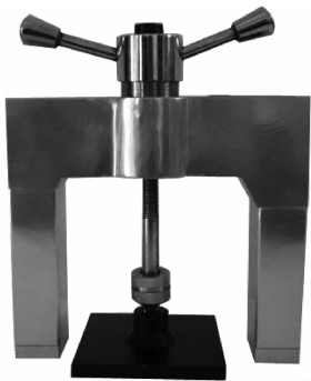
图 2-9 保温材料强度拉拔力检测仪
