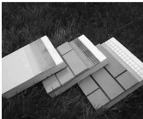
图 2-2 EPS 板薄抹面外保温系统
