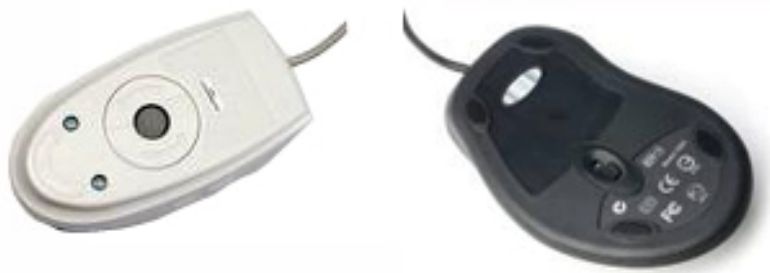
图 2-11-6 机械鼠标与光电鼠标背部比较
