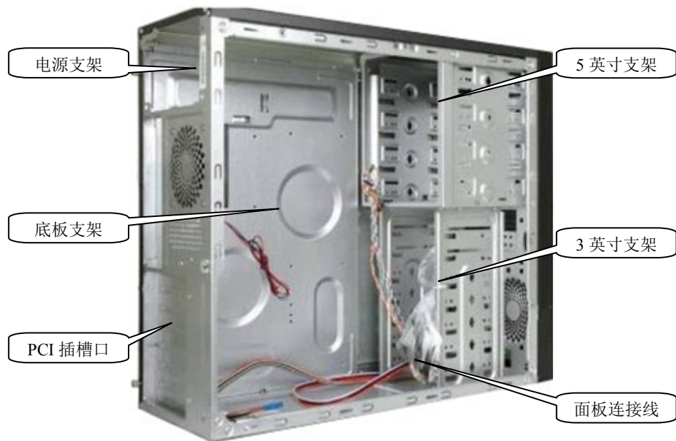
图 2-9-2 机箱内部结构
