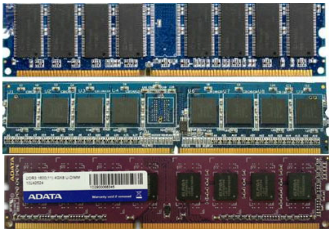
图 2-3-8 DDR 与 DDR 2、DDR 3 对比图
