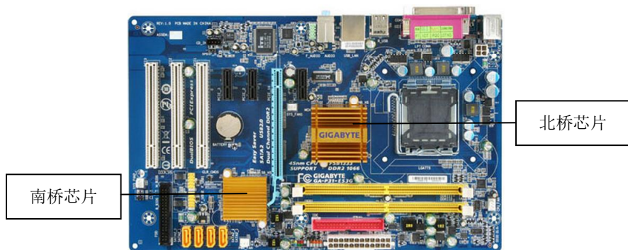
图 2-2-6 早期主板的南北桥芯片方式
