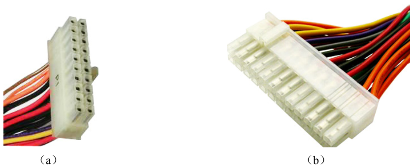
图 2-9-5 ATX 20 针与 24 针电源接口
