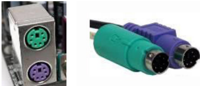
图 2-11-10 PS/2 接口对应关系
