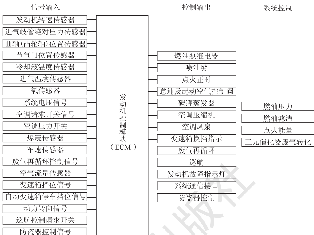
图 1-1-12 德尔福发动机电子控制系统框图
