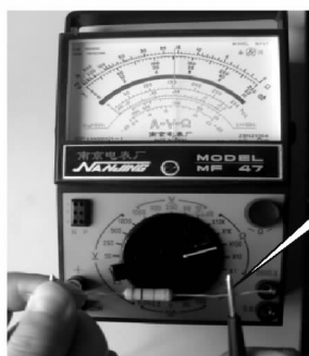
图 1.28 万用表测量电阻
