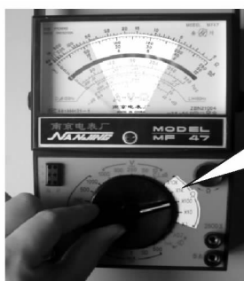
图 1.26 万用表选电阻挡挡位
