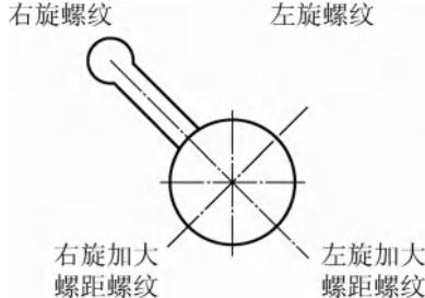
图 2-2-7 螺纹旋向的变换操作
