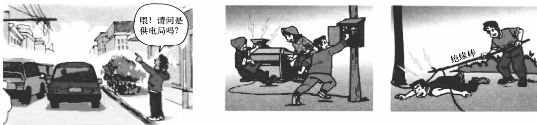
图 1-30 发生高压触电时脱离电源的方法
