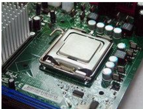
图 1-13 CPU 安装好的效果
