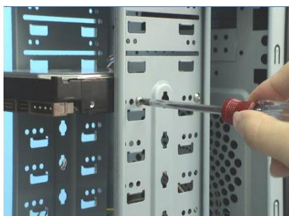
图 1-43 在驱动器舱中固定硬盘
