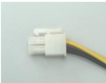
图 1-26 4 芯 CPU 供电插头
