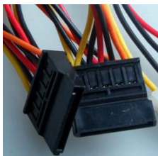
图 1-28 串口硬盘电源插头
