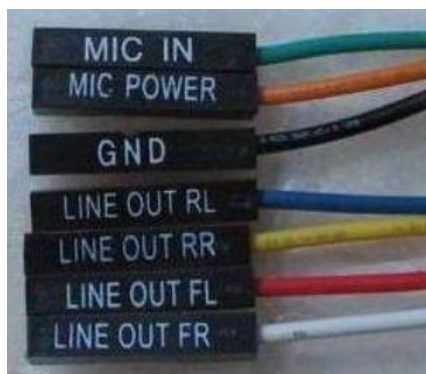
图 1-38 耳机和 MIC 连线
