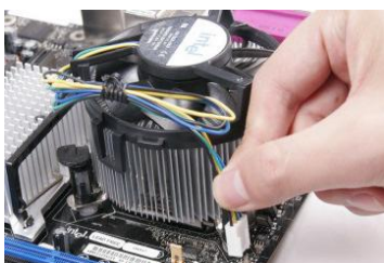
图 1-16 安装风扇电源插头
