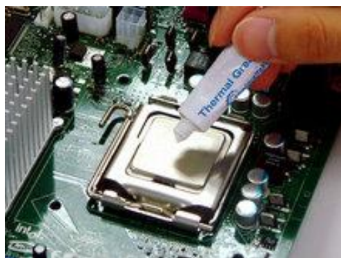
图 1-14 在 CPU 表面涂抹少量硅胶
