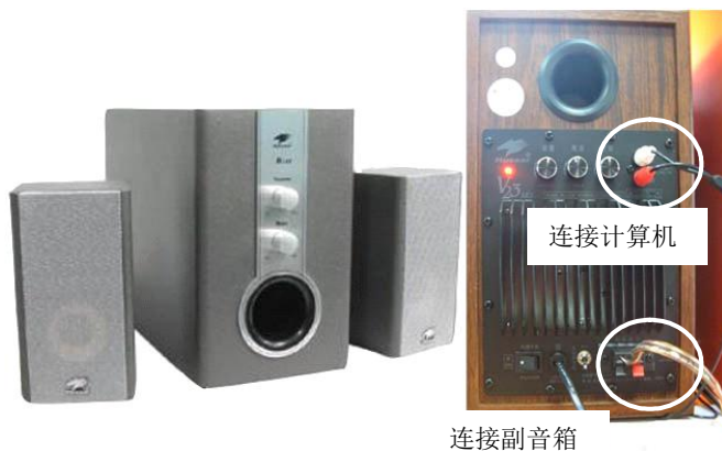
图 1-51 音箱连接示意图
