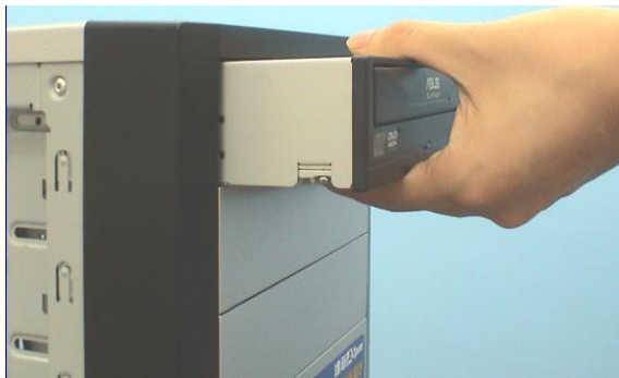
图 1-48 安装光驱示意图
