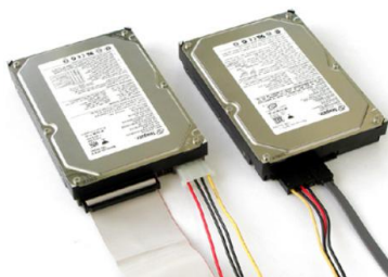
图 1-47 两种接口硬盘连接对比图
