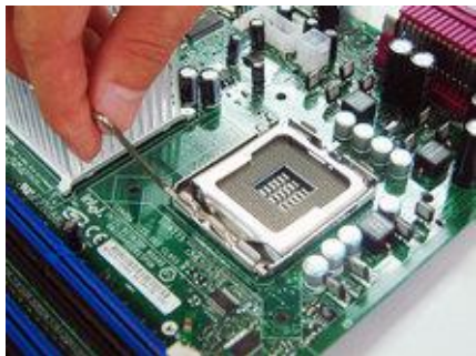
图 1-10 拉起 CPU 插槽侧面的手柄
