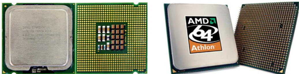
图 1-4 Intel 和 AMD 的 CPU 外观结构图
