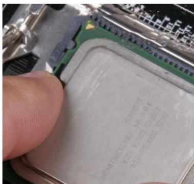
图 1-12 安装 CPU 示意图
