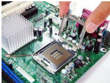
图 1-11 打开 CPU 插槽上的扣盖
