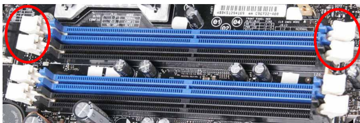
图 1-17 内存插槽及两边的卡子
