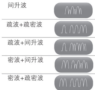
图 2-2 间动电流的脉冲波形示意图
