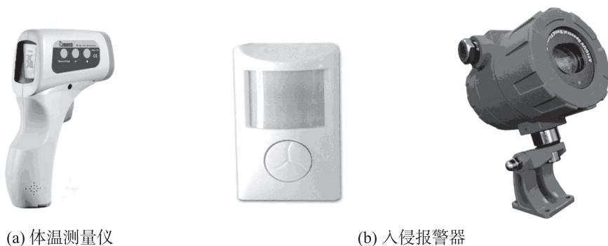
图 1-3-6 热释电传感器应用
