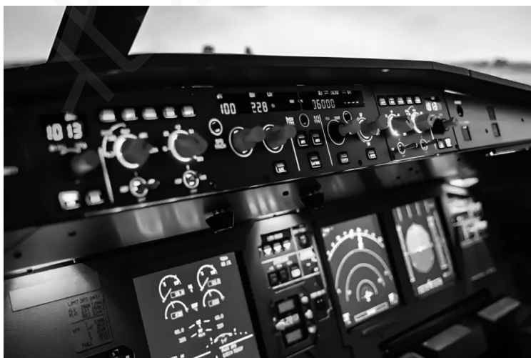
图1-12 飞机自动驾驶仪
