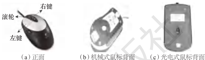
图 1-16 鼠标的正面、机械式鼠标的背面、光电式鼠标的背面
