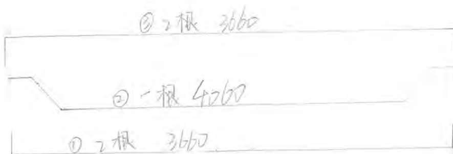
8-3 根据梁配筋图和截面图，按 1:40 比例画出①~④号钢筋，并标注长度及数量
