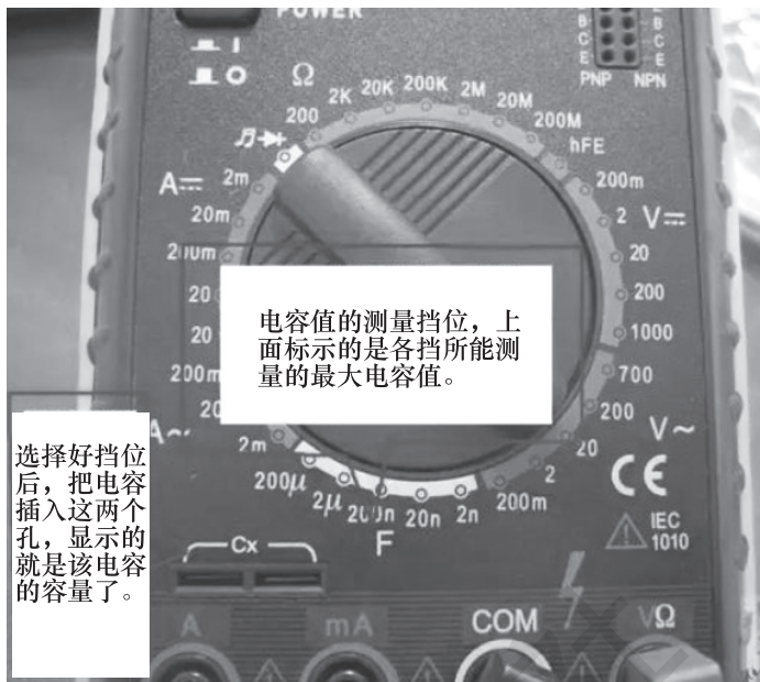
图 2-1-12 应用数字万用表测量电容
