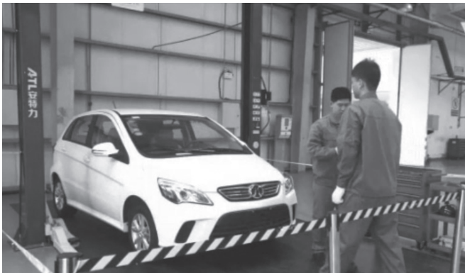
图 1-2-3 高压作业现场环境检查
