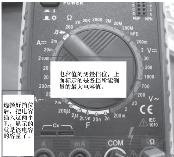
图 2-1-12 应用数字万用表测量电容
