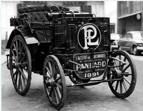
图 1-28 潘哈德汽车公司的前置发动机后轮驱动汽车
