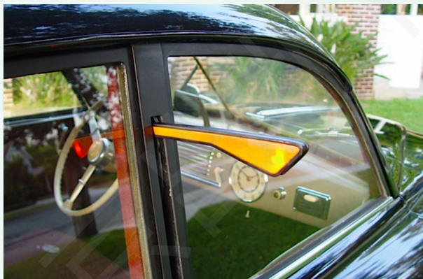
图 1-39 安装在车身两侧的转向信号臂
