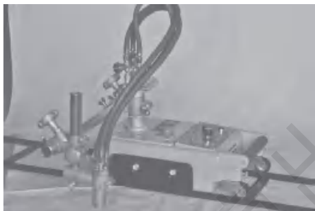
图 1-3-12 半自动气割机下料小板
