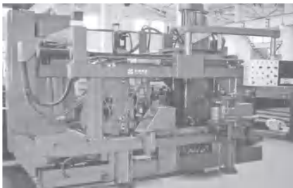
图 1-3-25 数控三向多轴钻床
