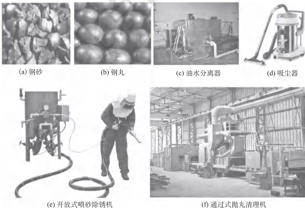
图 1-5-5 抛丸、喷砂除锈设备
