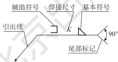
图 1-1-1 钢结构焊缝表示方法
