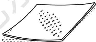
图 1-3-36 弯曲变形薄板矫正
